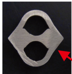
焊缝在非关键拐弯处，无任何尺寸变化
