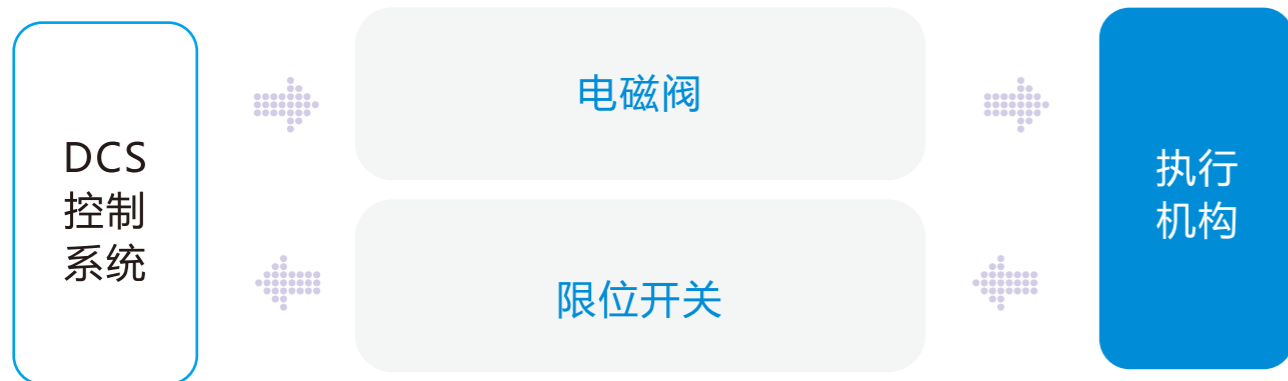
气动开关阀工作原理图
